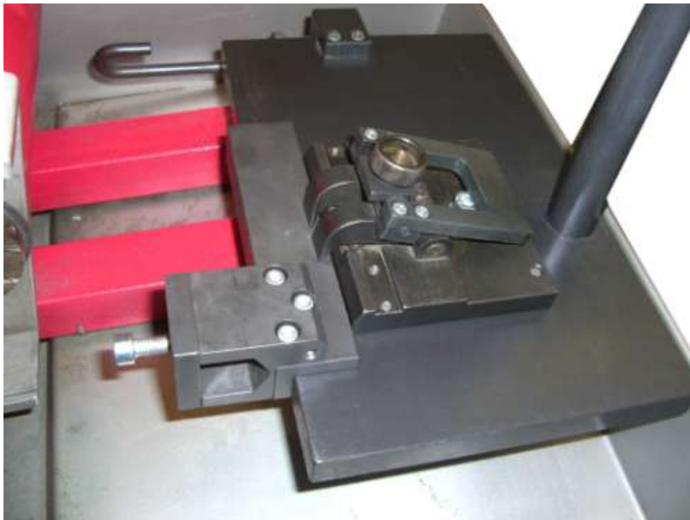
Spannvorrichtung 377.17.180.00 und 377.17.185.00 zum Spannen von runden Werkstücken bis \varnothing 25mm.
