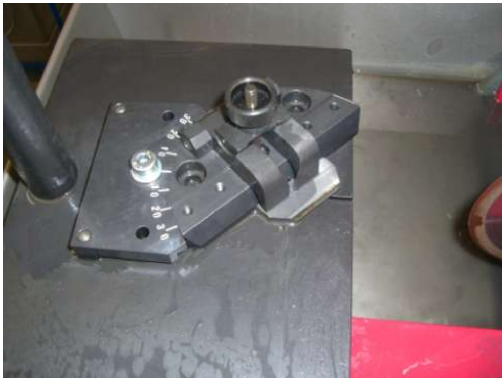
Spannvorrichtung Schrägschnitt 377.17.150.00 zum Trennen der Werkstücke mit einer Schräge bis 45°
